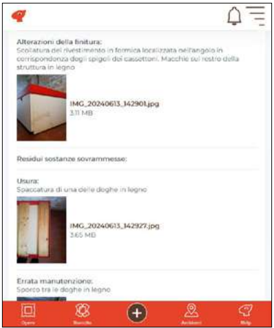
07. Sistema di schedatura digitale, dettaglio di una scheda: descrizione dello stato conservativo di un elemento di arredo. | Digital cataloguing system, detail view of a record: description of the conservation status of a furnishing element.
