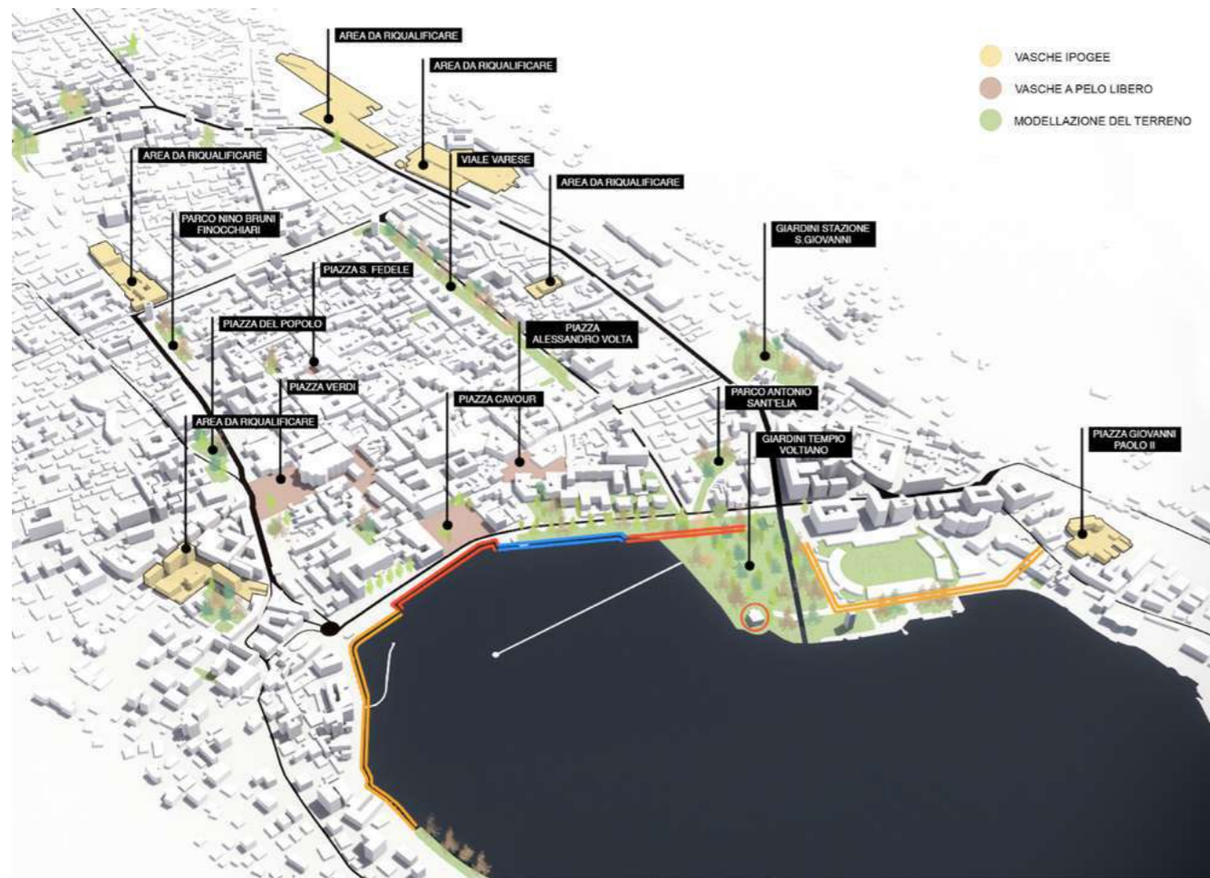
04. Possibili aree di localizzazione dei serbatoi diffusi per trattenere le acque a monte | Possible localization areas of diffused reservoirs to retain upstream waters
