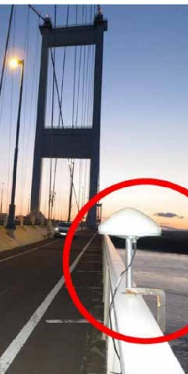
Monitoraggio dello spostamento di strutture mediante GNSS e altri sensori
