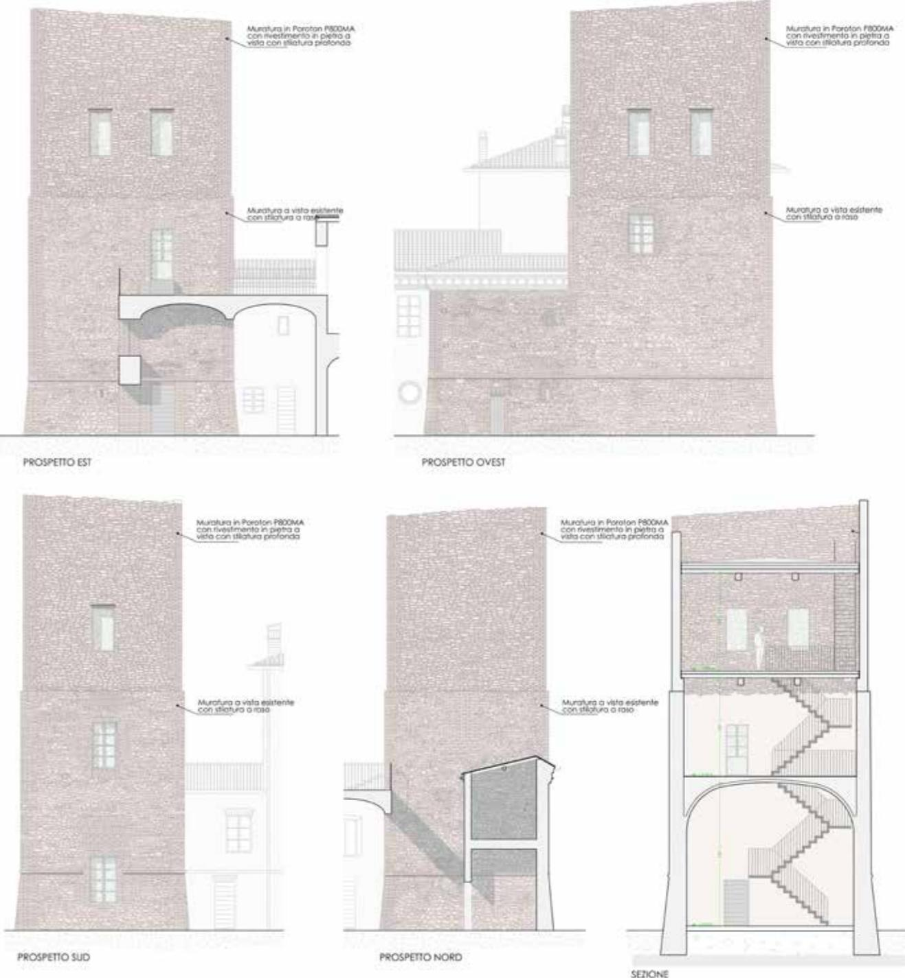
Prospecti e sezione della casa-torre relativi al progetto di restituzione della configurazione volumetrica originaria: viene proposta la parziale ricostruzione della porzione sommitale del fabbricato con un trattamento esterno delle
