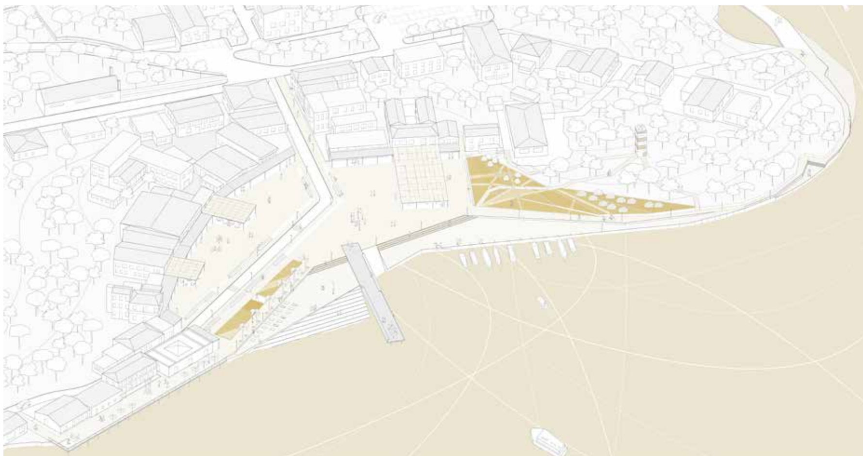
Il progetto del nuovo waterfront che include la realizzazione di un piccolo giardino botanico sulla Ponta do Morretes, la creazione di una pensilina per il mercato del pesce e la ristrutturazione dell'adiacente piazza
