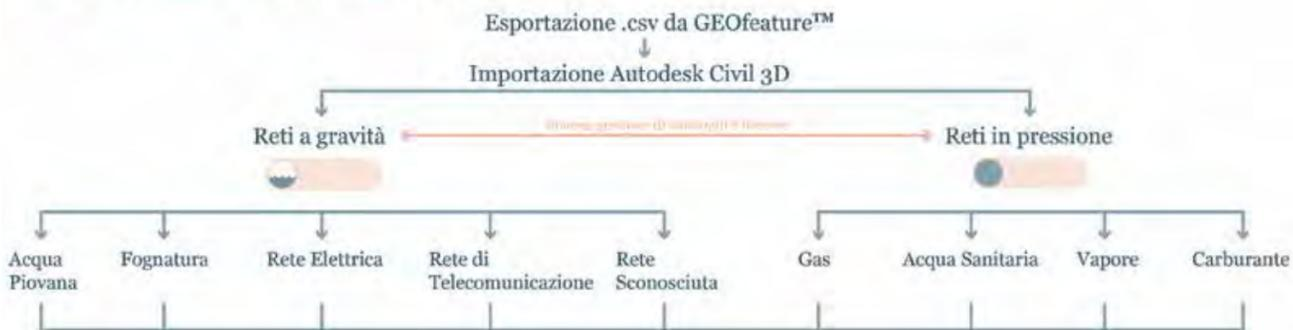
I dati vengono successivamente esportati ed elaborati da algoritmi di modellazione parametrica proprietari per la creazione automatica dei tracciati delle reti. L'uso di algoritmi consente di ottimizzare i tempi di modellazione BIM, in cui viene creato un modello per ogni tipologia di rete
