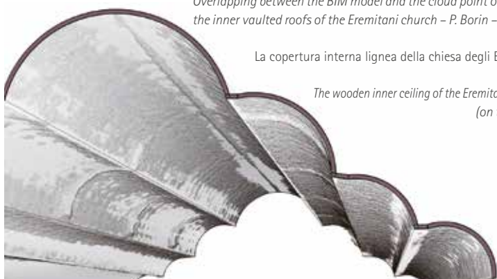
Sovrapposizione tra il modello BIM e la cloudpoint della copertura interna della chiesa degli Eremitani – P. Borin – (in basso)
