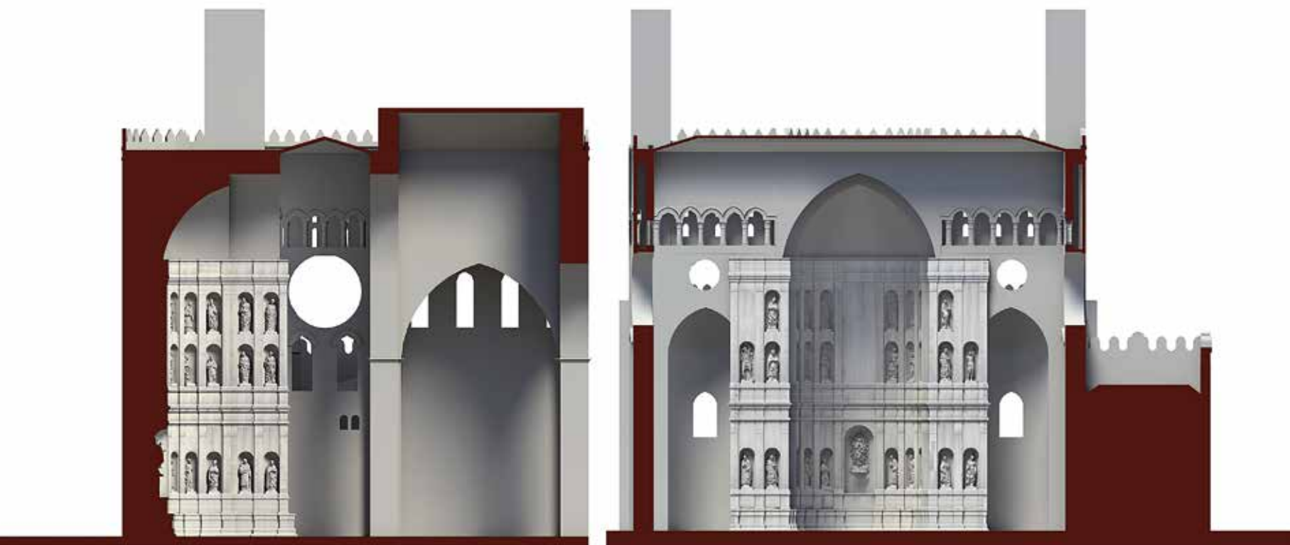
■ Sezioni della parte absidale con la Tribuna (in alto) e assonometria della parte absidale con la Tribuna (in basso); © C. Lo Franco Section of the absidal part with the Tribune (above) and axonometric view of the absidal part of the Tribune (below); © C. Lo Franco
