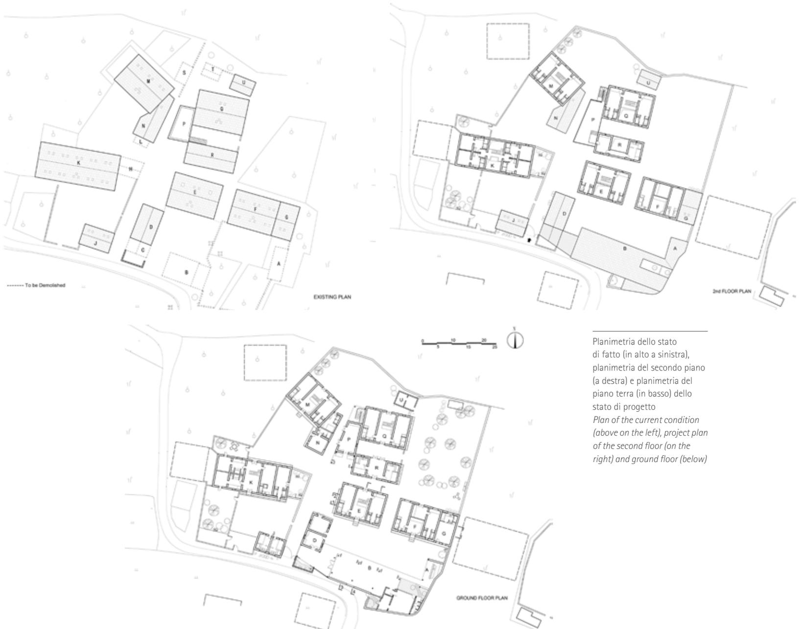
Planimetria dello stato di fatto (in alto a sinistra), planimetria del secondo piano (a destra) e planimetria del piano terra (in basso) dello stato di progetto
