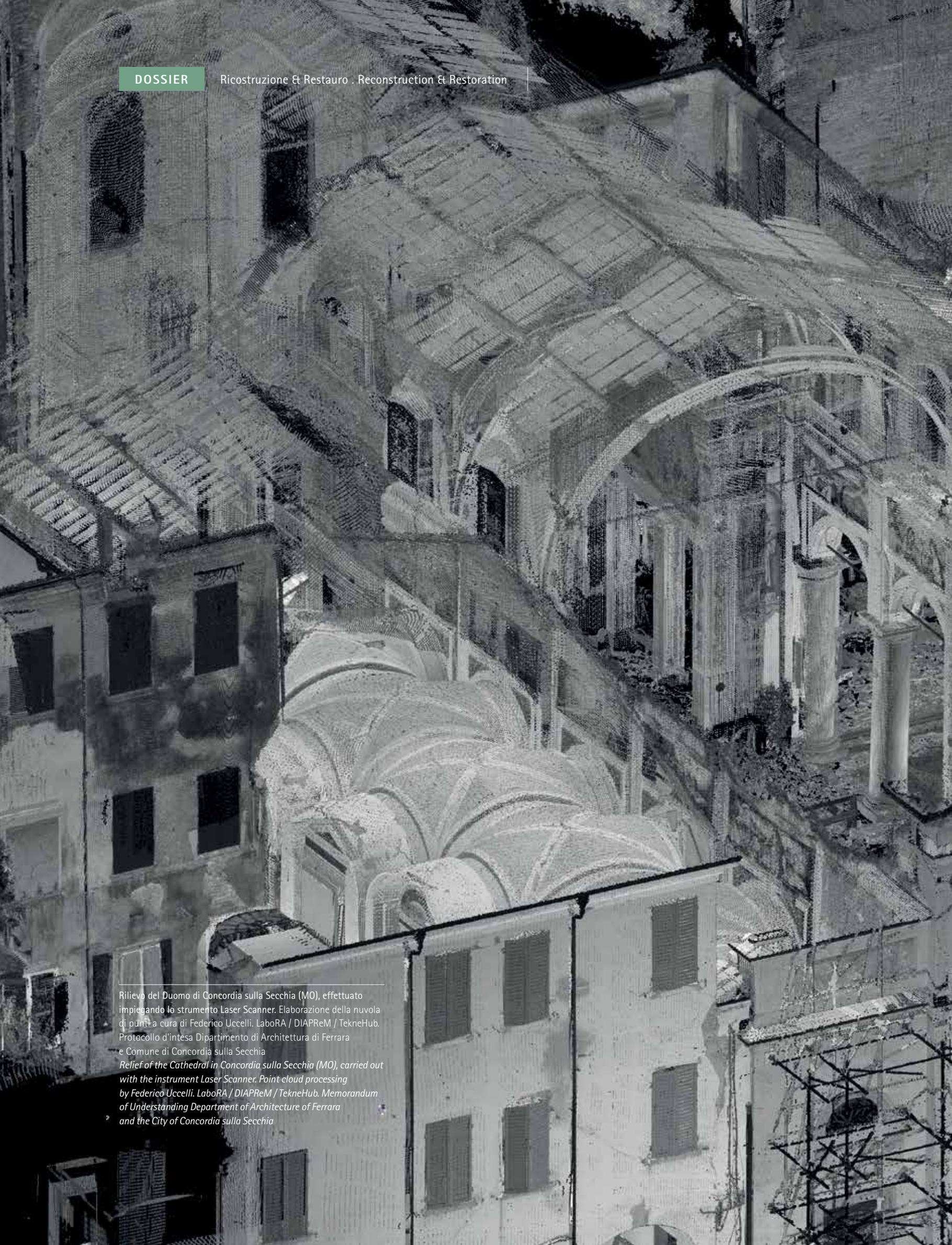
Rilievo del Duomo di Concordia sulla Secchia (MO), effettuato impiegando lo strumento Laser Scanner. Elaborazione della nuvola di punti a cura di Federico Uccelli. LaboRA / DIAPReM / TekneHub. Protocollo d'intesa Dipartimento di Architettura di Ferrara e Comune di Concordia sulla Secchia
