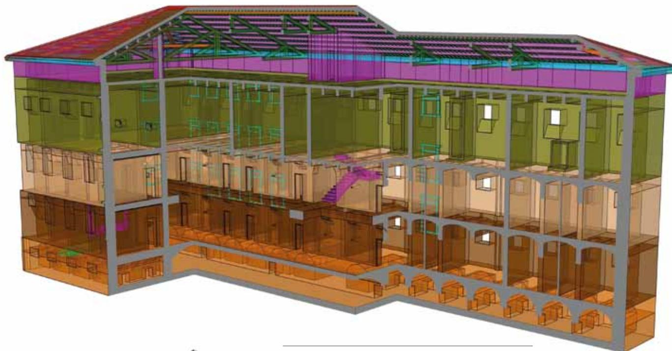
Elaborazioni tridimensionali CAD da nuvola di punti: spaccato assometrico dell'edificio (in alto) e vista prospettica di una porzione di nuvola di punti sezionata al livello del terzo piano (di lato)
