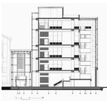
Sezione longitudinale degli spazi espositivi di Santralistanbul Longitudinal section of the Exhibition areas inside Santralistanbul
