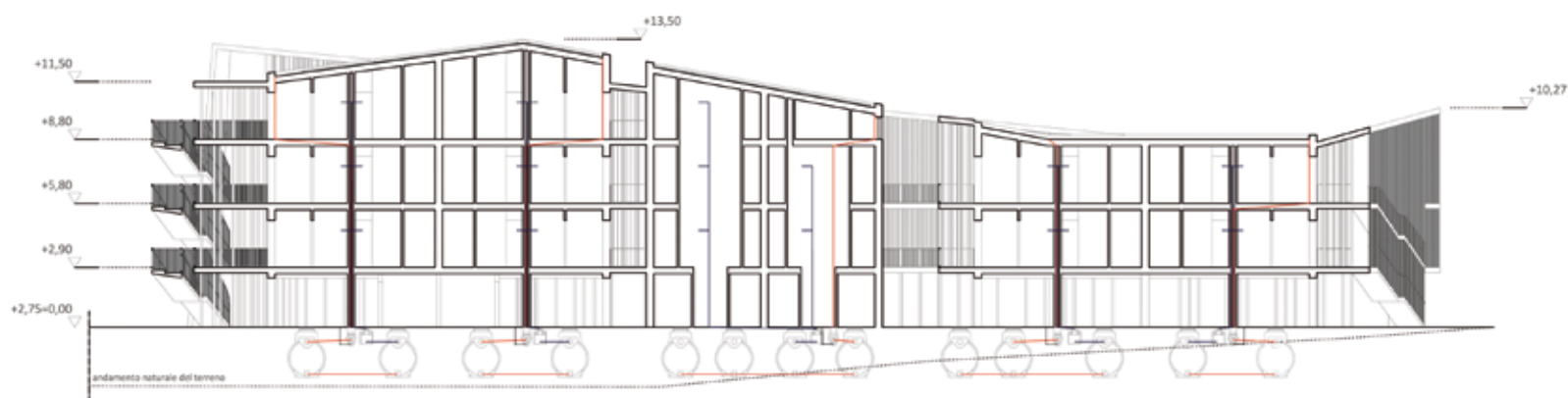
Sezione B-B con schema del circuito di riuso delle acque piovane B-B section and diagram of rainwater reuse circuit
