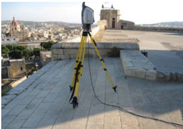
Viste delle fasi di rilievo mediante laser scanner 3D a tempo di volo in diversi contesti della Cittadella
