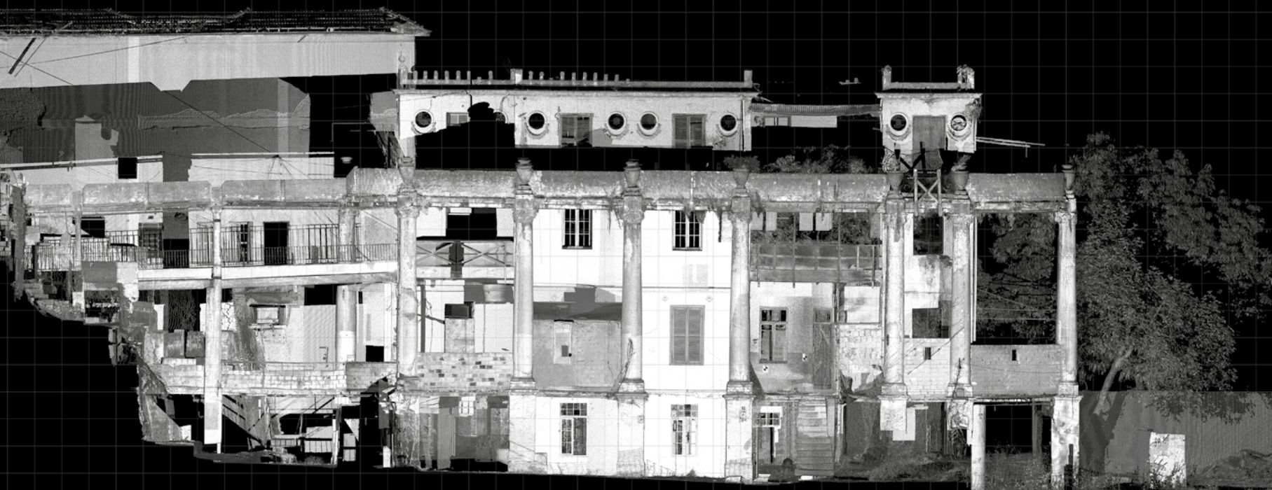
Prospetto estratto da database 3D a nuvola di punti della Vila Itororó, maglia 1x1 m; © Daniele Felice Sasso (in alto) Facade of Vila Itororó by 3D point cloud database, grid 1x1 m; © Daniele Felice Sasso (above)
