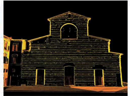
Interrogazione del database 3D nella zona della facciata della chiesa di San Lorenzo. La visualizzazione, che si determina attraverso una silhouette in trasparenza, consente di leggere con maggiore efficacia la geometria
