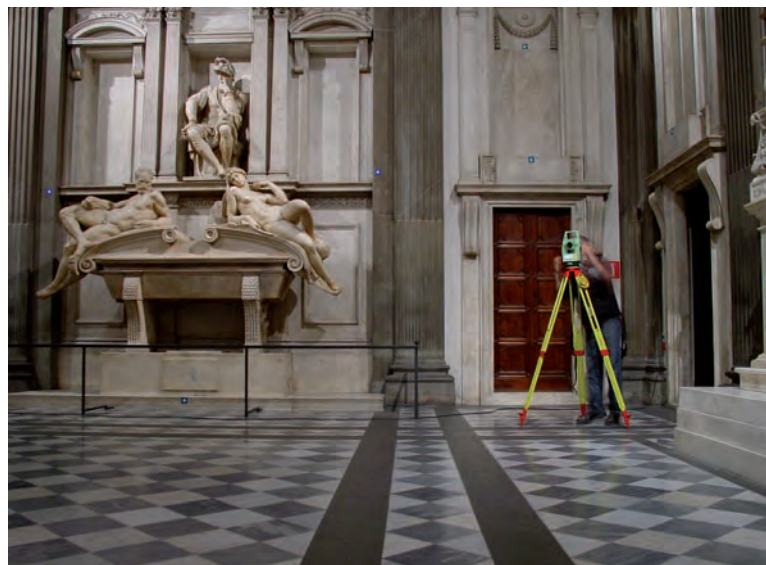
Integrazione di rilievo topografico nella Sagrestia Nuova per ottimizzare il rilievo 3D
