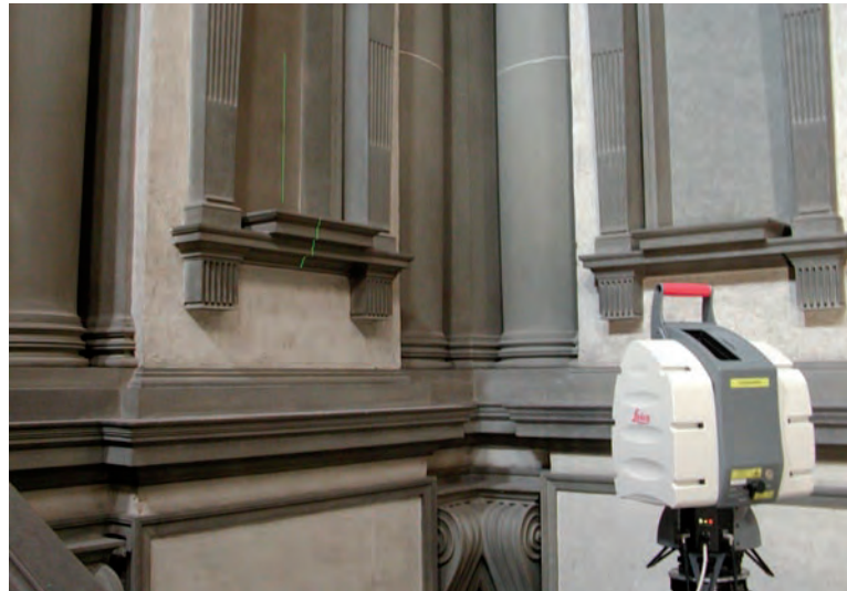
Il laser scanner HDS 3000 della Leica Geosystems durante il rilievo 3D del vestibolo della Laurenziana
