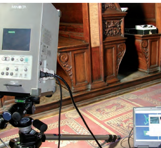
Integrazione di rilievo topografico nella Sagrestia Nuova per ottimizzare il rilievo 3D
