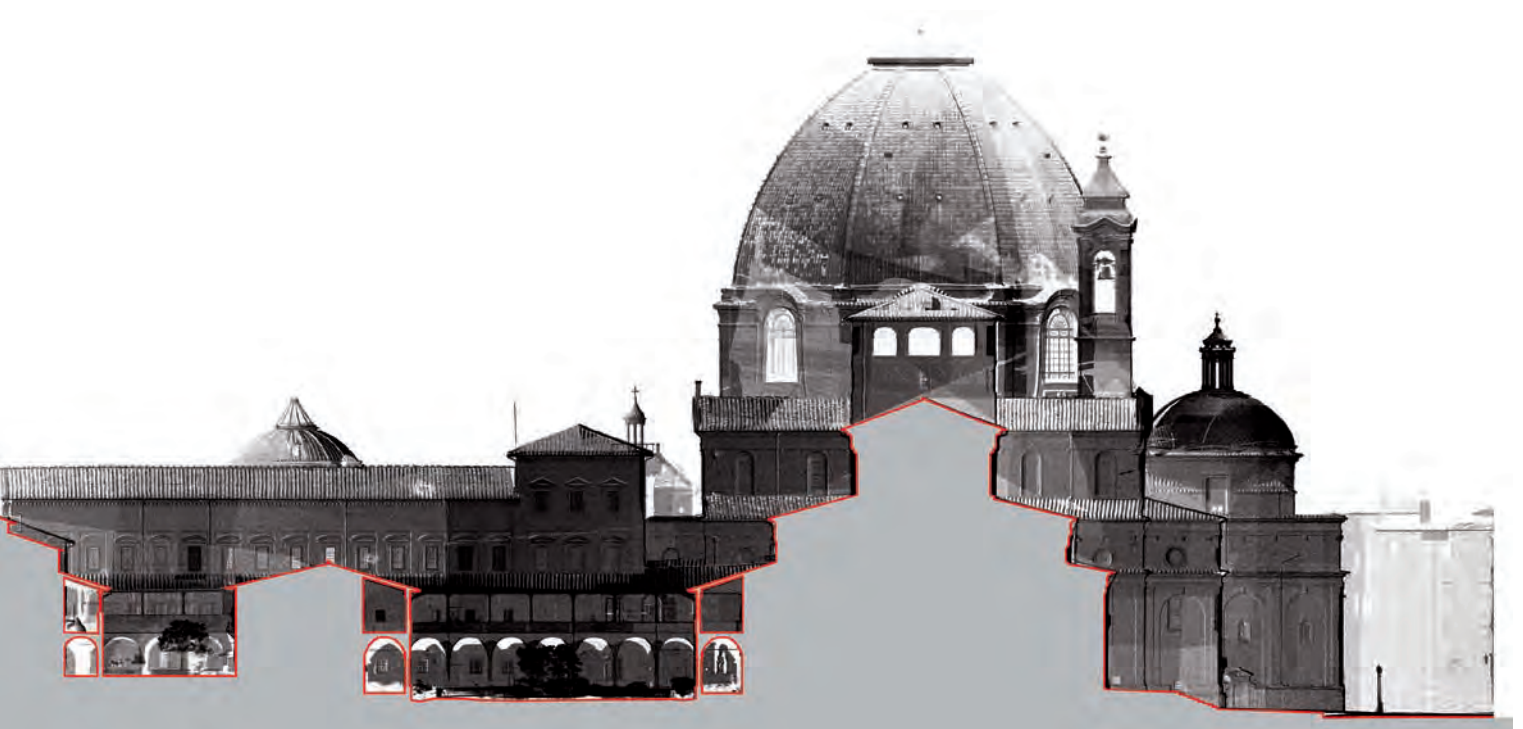
Visualizzazioni delle coordinate metriche estratte dal database 3D operando lungo l'asse longitudinale A-A' del complesso (i dati sono in versione silhouette). La visualizzazione, che si determina attraverso una silhouette in trasparenza, consente di avere a disposizione contemporaneamente la percezione morfometrica tra oggetti di cornici e confini strutturali
