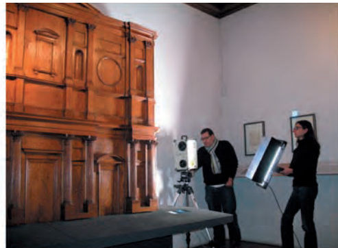
Fasi di acquisizione con laser scanner 3D ad alta definizione Konica-Minolta VI-910
