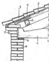
copertura con capriata lignea
