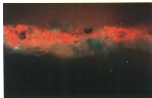
Sezioni lucide realizzate a partire da scaglie di pellicola pittorica dei ritocchi scuri: le analisi evidenziano la presenza di ocre rossa ed ematite, quindi la presenza di un colore scuro, e l'assenza di leganti organici, che se alterati avrebbero potuto dare un tono scuro al colore originario
