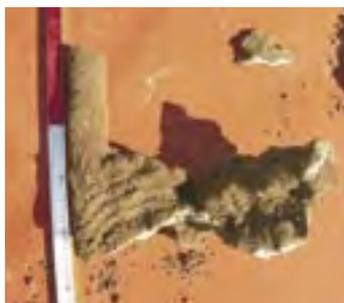
**Prematek** propone, per il consolidamento e la stabilizzazione dei terreni, la tecnica delle iniezioni di resine espandenti. Questo procedimento consente di accrescere la stabilità del terreno migliorandone, con un effetto di costipazione, le caratteristiche di resistenza meccanica. Il brevetto si avvale del sistema espandente **Impro** che consiste nell'effettuare
