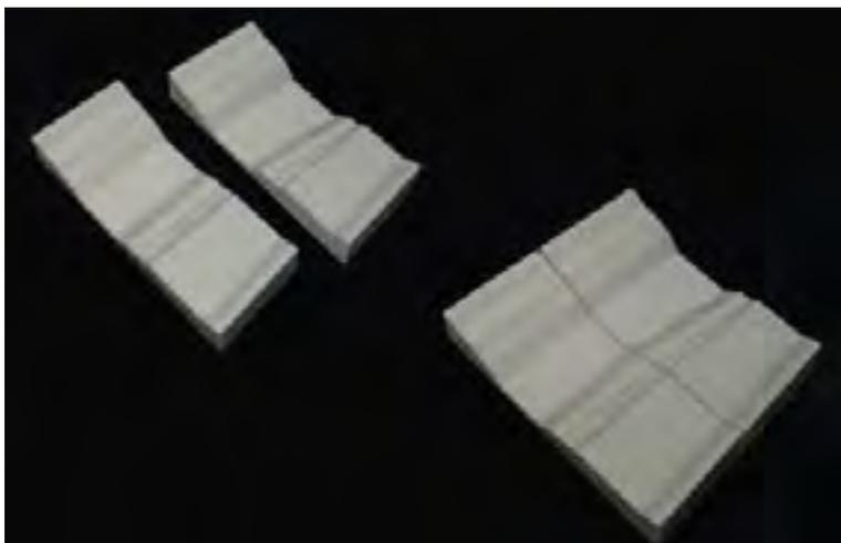
*Prototipo in gesso infiltrato realizzato con la stampante tridimensionale Z406, distribuita in Italia dalla CMF Marelli, della porzione dell'alveo del fiume composto da due elementi ricongiungibili (modello in scala 1:500)*
