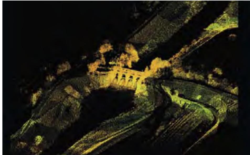
*Modello metrico a nuvola di punti 3D dell'alveo del fiume Montone e della chiusa di San Marco*
