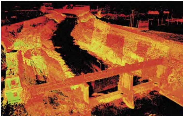
Modello metrico della chiusa di Castiglione di Cervia sotto forma di nuvola di punti visualizzato con il dato di riflettanza
