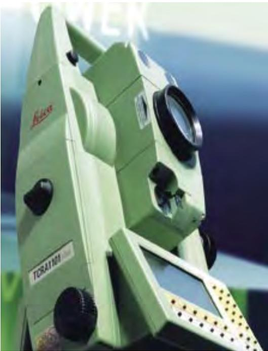
La stazione totale Leica TCR 1101 che ha consentito di acquisire con elevatissima precisione i target (punti di riferimento acquisiti anche dal laser scanner) e i punti fiduciali esterni
