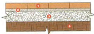
Pavimentazione non murata
