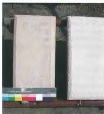
Prime campionature di malte messe a punto dal centro ricerche Fassa Bortolo e applicate su tavelloni in laterizio collocati all'aperto, in condizioni di esposizione agli agenti atmosferici simili a quelle che dovranno sopportare dopo la posa in opera, al fine di testarne le caratteristiche ed il comportamento fisico-meccanico
