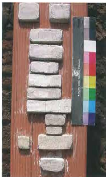
Tavellone su cui sono state applicate le campionature di malte realizzate in cantiere con materiali naturali sulla base di ricette usualmente utilizzate a Pompei
