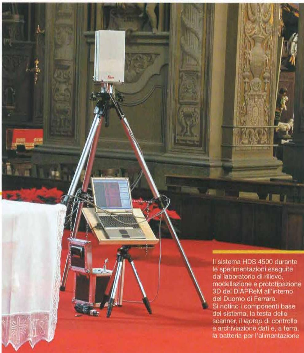
Il sistema HDS 4500 durante le sperimentazioni eseguite dal laboratorio di rilievo, modellazione e prototipazione 3D del DIAPReM all'interno del Duomo di Ferrara. Si notino i componenti base del sistema, la testa dello scanner, il laptop di controllo e archiviazione dati e, a terra, la batteria per l'alimentazione
