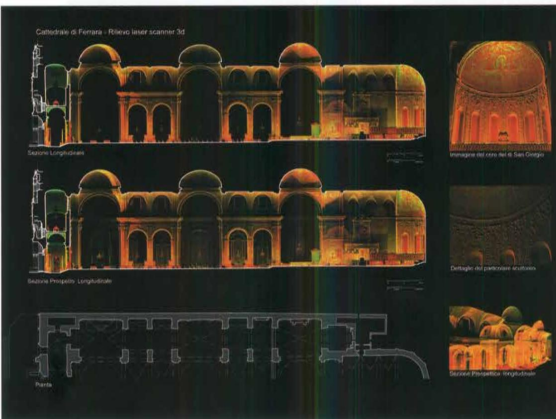
Elaborazioni in proiezione ortogonale dell'impianto interno del Duomo di Ferrara
