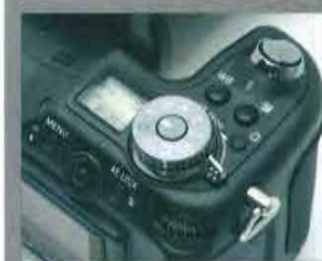
Dettaglio della ghiera di selezione dei programmi e del display superiore
