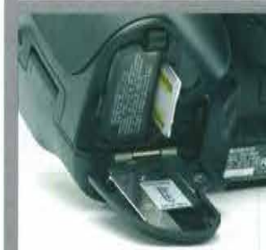
Particolare dell'alloggiamento per Memory Stick Pro e della batteria InfoLITHIUM
