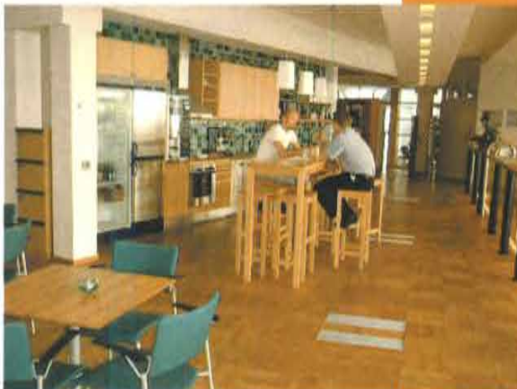
Eliminati i controsoffitti e posto l'impianto a pavimento ogni ambiente guadagna più spazio. Semplicità e pre-ingegnerizzazione sono da sempre elementi fondamentali del Sistema Spazio flessibile. (nella foto Saab, Svezia, 10.000 mq)
