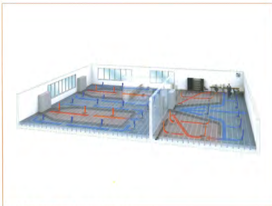
Hiross C System: mandata e ripresa a pavimento
