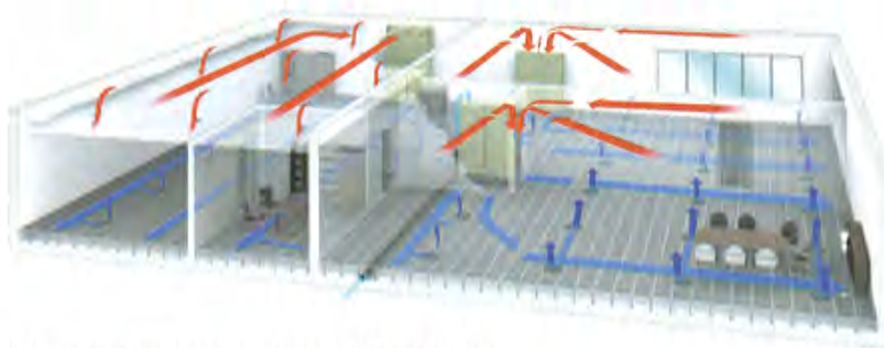
Hiross V System: mandata a pavimento e ripresa dall'alto
