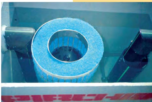
Particolare del filtro a coalescenza: cartuccia e dispositivo di otturazione automatica con galleggiante
