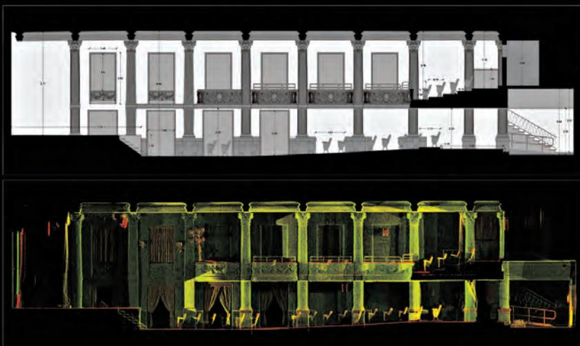
*Sezioni longitudinali condotte lungo i volumi della Sala Estense, elaborazione al CAD (scala 1:50) ed immagine ortogonale della sala ottenuta tramite il software Cyclone TM*
