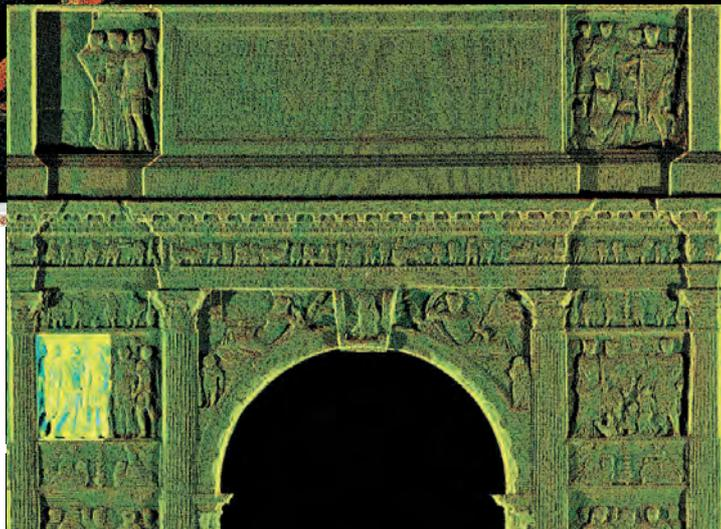
Visualizzazione di particolare in cui risulta visibile il grado di acquisizione con la doppia maglia di rilievo (4x4 cm di inquadramento e 1x1 cm di dettaglio)
