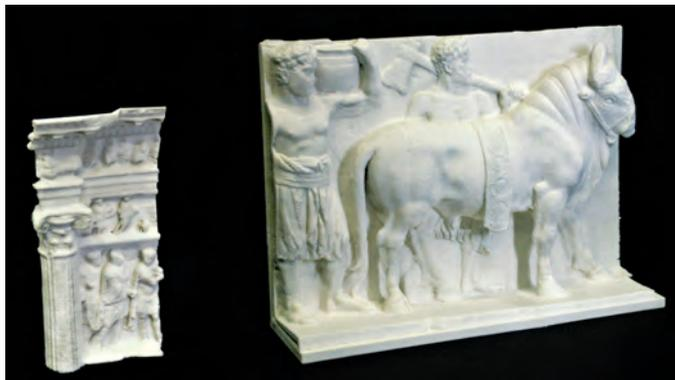
Confronto tra una prima sperimentazione di prototipazione solida realizzata in scala 1:20 dai dati di scansione Cyrax con la formella in scala 1:2 (quattro elementi prototipati saldati insieme) generata dai dati 3D dello scanner Minolta Vivid 900i
