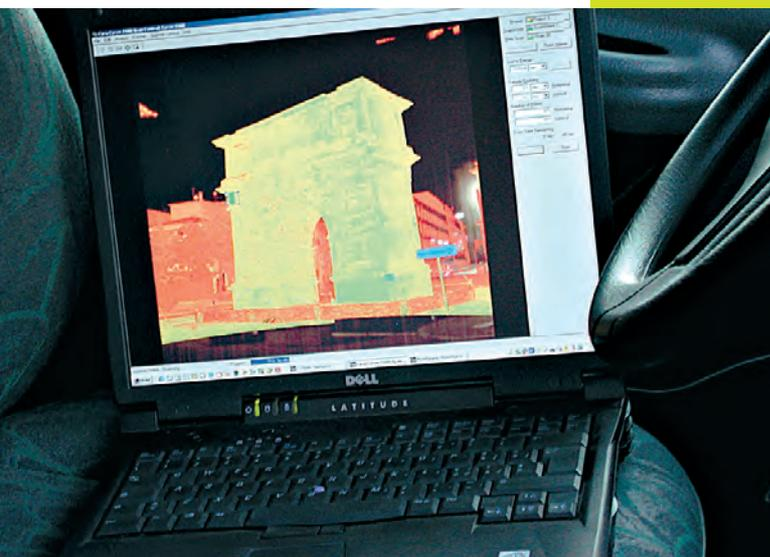
Gestione dei dati durante la fase di acquisizione. Sul laptop è possibile visualizzare direttamente i dati di rilievo mentre vengono riprodotti dal software Cyclone
