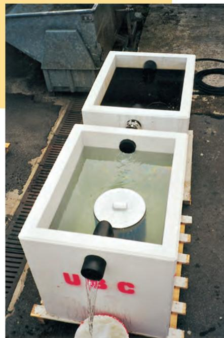
La norma 858-1 prevede lo svolgimento di una prova di tenuta per i dispositivi di chiusura: la perdita non deve superare 100 NS del separatore, in millimetri, per un periodo di 15 minuti
