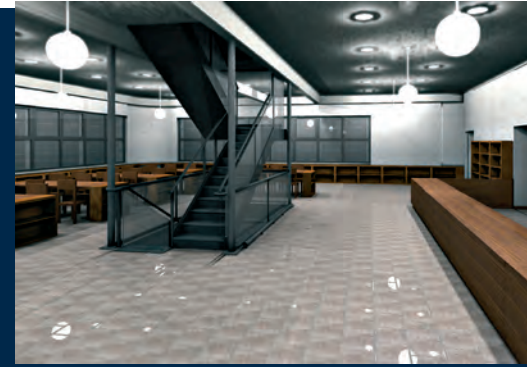
Ala nord: sezione e vista del corridoio su cui si aprono le salette lettura su doppio livello. Sullo sfondo la bussola relativa al nuovo accesso creato dall'interno della corte. L'arredamento interno, appositamente progettato, è caratterizzato dall'utilizzo prevalente del legno accoppiato a tubolari in acciaio satinato, in continuità con la tipologia ricorrente dei parapetti originali. Sulla destra il bancone informazioni-prestito nella sala lettura adulti
