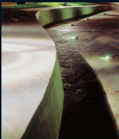
Dettaglio della doppia illuminazione delle curve: pali bassi e incassi a pavimento
