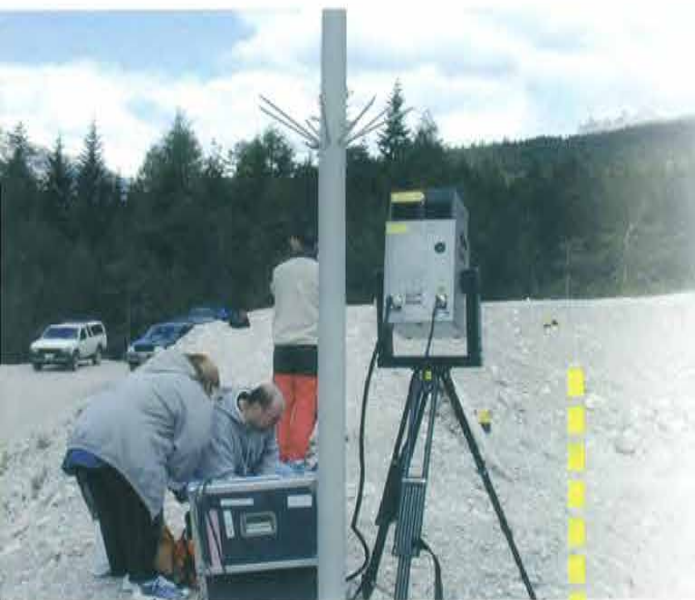
Il Nub Lab di Ferrara durante la scansione della frana a Cortina d'Ampezzo con il Cyrax 2400
