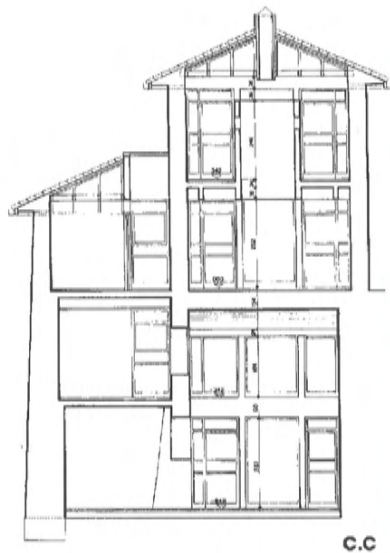
Sezione trasversale nella quale si notano a sinistra il piano d'ingresso e a destra il piano di calpestio della sala in continuità con l'uscita sul centro storico
