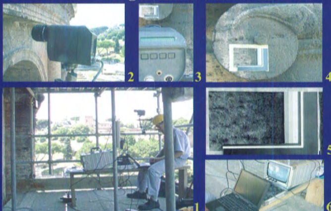
1) Set di ripresa 2) Telefotometro con ottica 50 mm 3) Particolare dello strumento e sullo sfondo la zona di misura 4) Capitello con la zona di misura 5) Standard di riferimento per la calibrazione delle misure 6) Monitor del telefotometro e collegamento con il notebook per l'acquisizione
