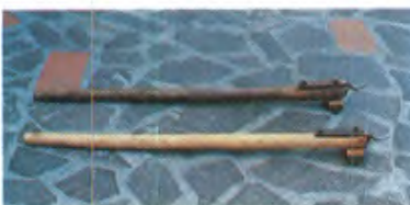
Attrezzi usati per la copertura ago e filo di ferro; ferro e filo di ferro; carga (leva); battola.
