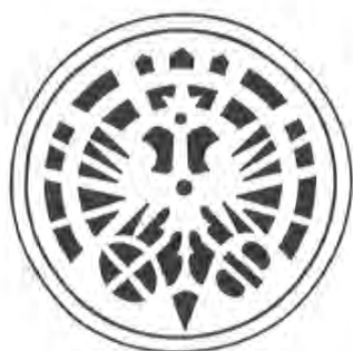
Tipologia A Soluzione con stemma del comune a traforo materiale: ottone / ghisa sferoidale
