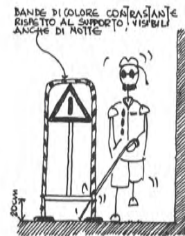
Segnale stradale temporaneo con alcuni accorgimenti che favoriscono la rilevabilità in tempo utile per ciechi deambulanti con bastone ed ipovedenti
