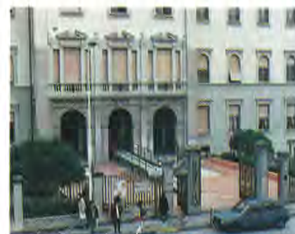
Il cortile dell'Istituto Nicolodi oggi, dopo l'intervento finalizzato a consentire l'accessibilità ai disabili su carrozzina. Sui pilastri della recinzione sono apposte insegne che, a causa del bassissimo contrasto rispetto allo sfondo, risultano scarsamente visibili
