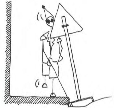
Pericolo di percorso. Segnale stradale temporaneo posizionato su strada conformata a "dorso di mulo"
