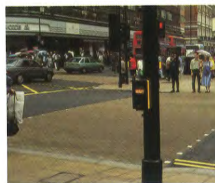
Oxford Street, Londra. Attraversamento pedonale in colore "buff" (giallo camoscio), contrastante cromaticamente con la sede stradale, per facilitarne la percezione visiva
