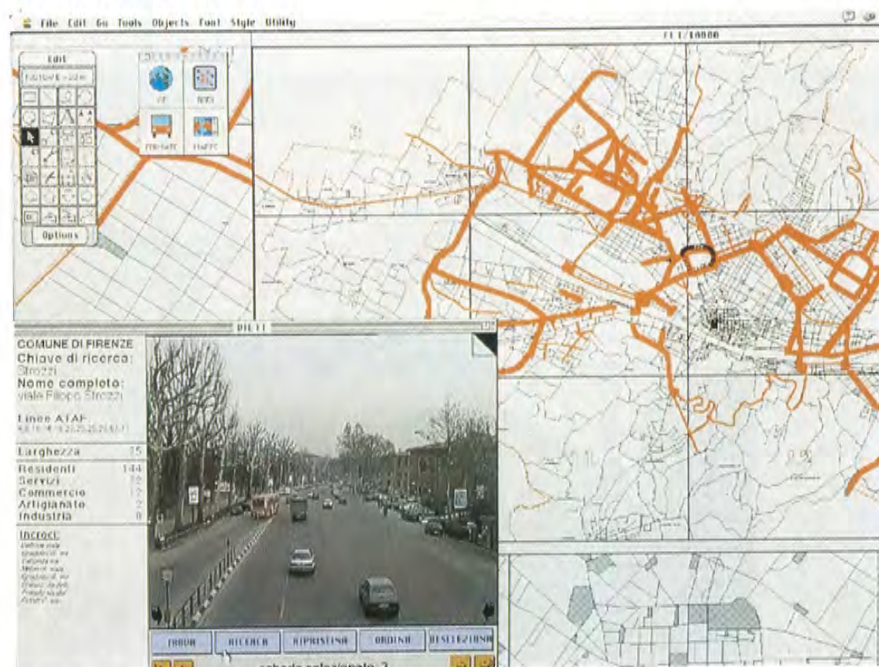
Archivio contenente le informazioni sulla viabilità ed evidenziazione sulla mappa digitale delle vie aventi una larghezza superiore ai 15 metri. Tramite le funzioni di ricerca del database è possibile selezionare tra migliaia di elementi quelli che possiedono determinate caratteristiche. Si ottiene quindi automaticamente una rappresentazione grafica per mezzo della mappa digitale
