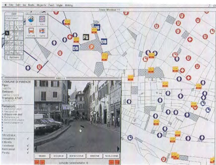
Mapa digitale con la evidenziazione della rete viaria rappresentata da archi e nodi. Selezionando un nodo sulla mappa vengono richiamate le informazioni relative memorizzate nell'ipertesto. Tali informazioni sono integrate dalle immagini digitalizzate ed in alcuni casi dalle riprese video. Le immagini e i video permettono di sintetizzare elementi utili ad una valutazione di impatto ambientale
