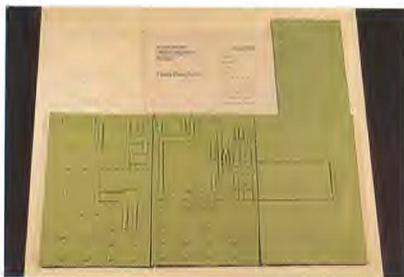
Pianta piano terra della scuola media "Beato Angelico" di Firenze elaborata dall'arch. Giovanni Orunesu della Stamperia Braille della Regione Toscana. La pianta è stata fatta ad uso di un ragazzo non vedente frequentante questa scuola
