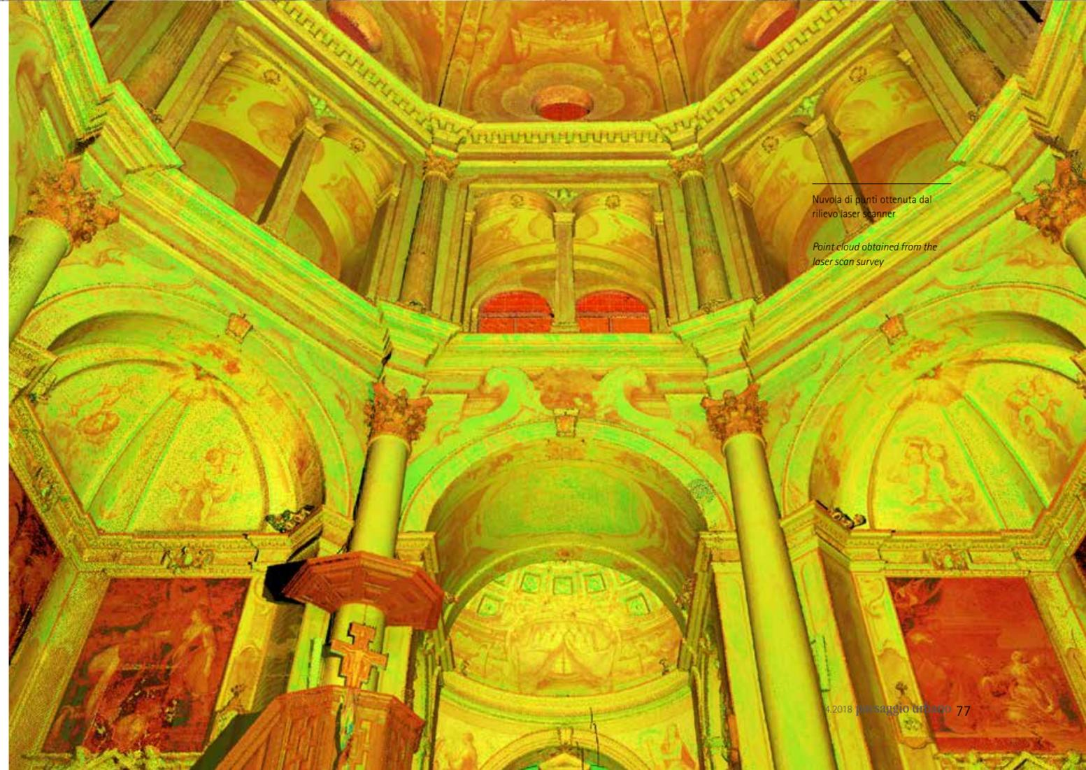
Nuvola di punti ottenuta dal rilievo laser scanner
