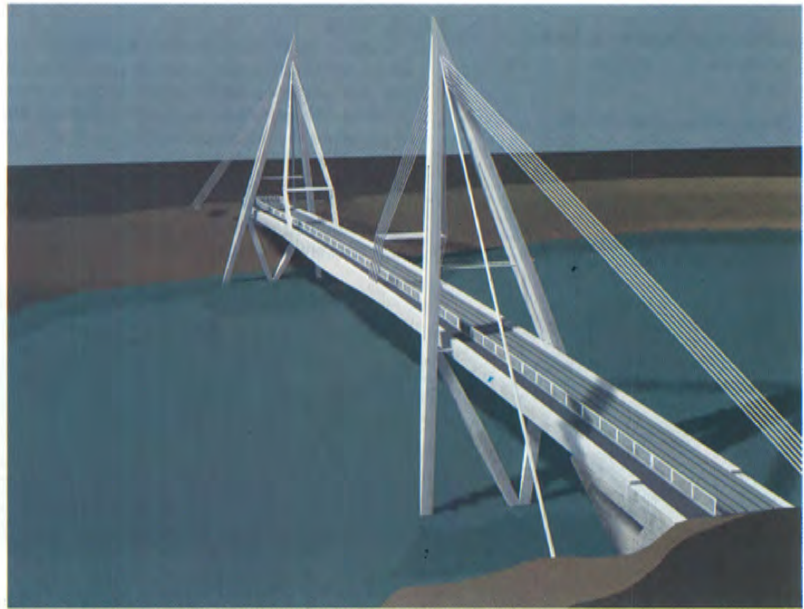
Ponte strallato a cavi paralleli - vista dall'alto
