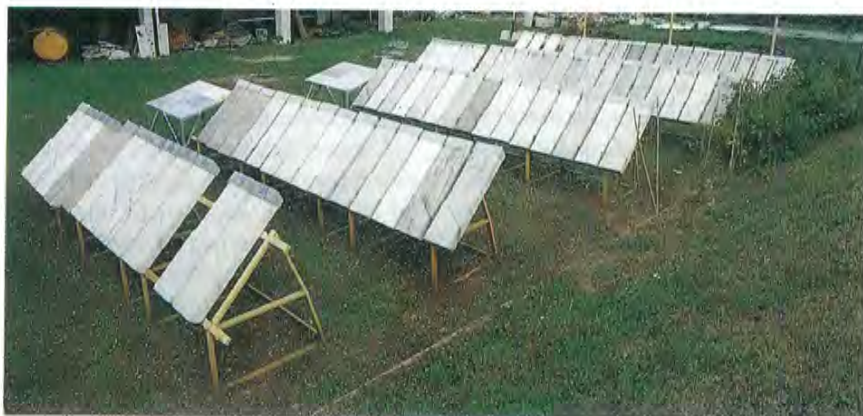
Il campo di esposizione di Cinisello Balsamo per sistemi di tinteggiatura e di pitturazione muraria, dopo 36 mesi
