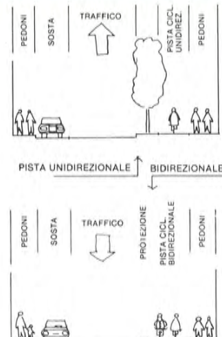
Traffico a senso unico, più fluido e sicuro. Sopra pista unidirezionale e sotto bidirezionale.
