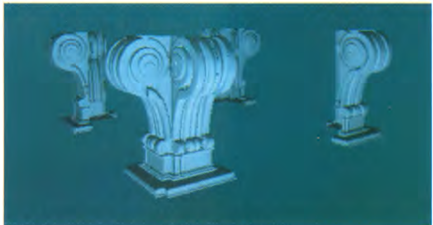
Volute di rafforzamento alle murature in sommità dell'Arco. Si osservi la sezione del profilo della voluta ed il suo avvolgimento.
