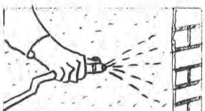
*Bagnare a pioggerella, per una settimana, la superficie intonacata per ritardare l'essiccamento, in modo da limitare possibili cavillature e rendere nel contempo più resistente l'intonaco. È opportuno bagnare al mattino per evitare choc termici che potrebbero danneggiare l'intonaco, creando contrazioni al proprio interno.*
