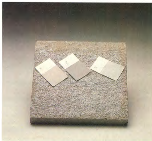
Esempio di ricerca per la ricostruzione di un tono con una tinta ad imitazione del colore della pietra.
