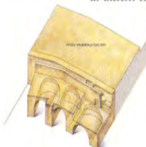
Speronature del "Murus Civitatis" per rinforzo strutturale dopo le manifestazioni di dissesti statici
